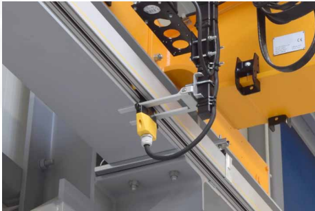
Abb.1: Stromabnehmer in der Stromschiene.
